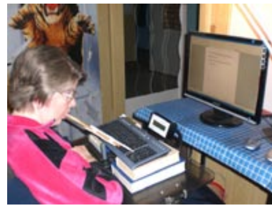
Abb. 3: Einfache mechanische Ausführung einer Kopfmaus. Mittels eines Mundstabes bedient die Betroffene eine normale PC-Tastatur. Foto: Wolfgang Ufer
