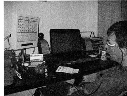
*Abb. 4: Elektronische Ausführung: Seitlich vom Kopf befindet sich ein Laserpointer, mit dem eine Tafeltastatur bedient wird.*
