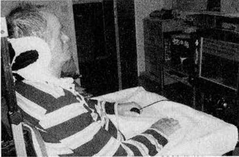
*Abb. 1: Patient, dessen Sprach-/Schreibcomputer im Scanning-Modus Zeilen-Spalten arbeitet. Zu sehen sind das Display der Kommunikationshilfe und der Taster in der linken Hand des Betroffenen.*
